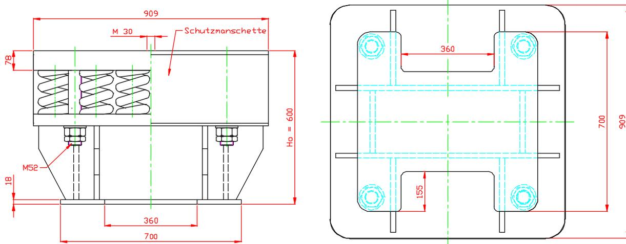
Federelement zur Abfederung schwerer Pressen bei niedriger Eigenfrequenz und mit unserer bewährten viskosen Dämpfung.
